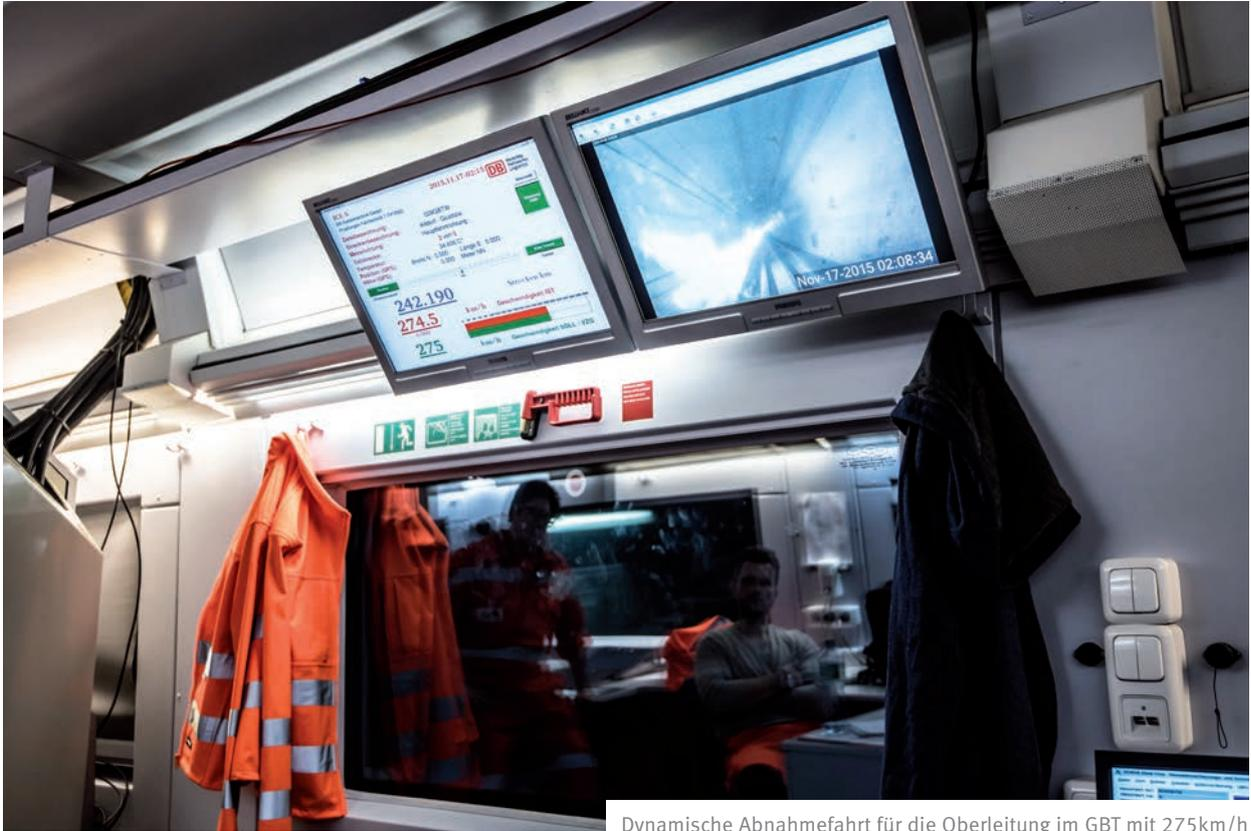
Dynamische Abnahmefahrt für die Oberleitung im GBT mit 275km/h
