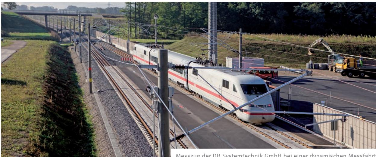
Messzug der DB Systemtechnik GmbH bei einer dynamischen Messfahrt
