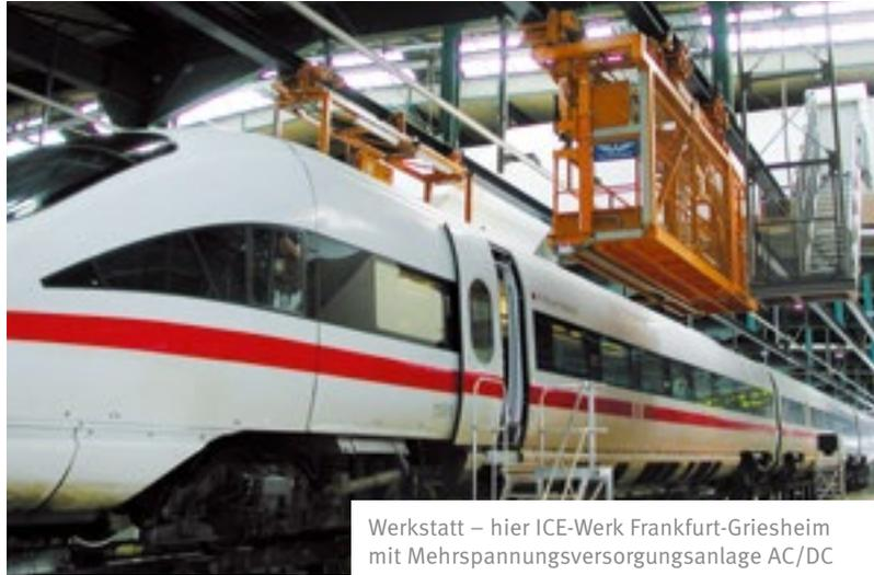
Werkstatt – hier ICE-Werk Frankfurt-Griesheim mit Mehrspannungsversorgungsanlage AC/DC
