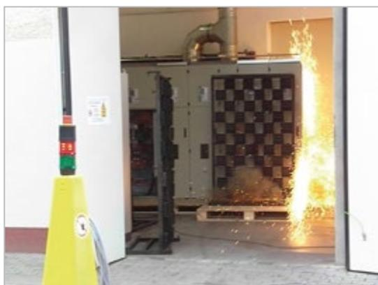
**Bild 2:** Austritt eines Störlichtbogens bei einer Prüfung mit einfacher Seitenwand.
